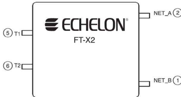
图 6b: 4 管脚表面贴式变压器 (前视图)
